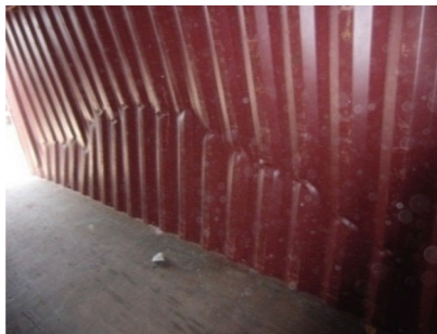
Figura 7.50 Pared lateral dañada de una unidad de transporte
