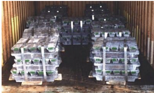
Figura 7.19 Lingotes de metal unificados con zunchos (sujeción incompleta)
