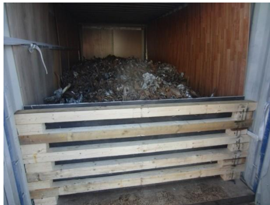
Figura 7.55 CTU com revestimento de parede e barreira da porta carregada com sucata
