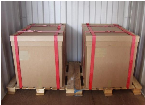
Figura 7.8 Carga firmemente presa a paletes por amarrações têxteis
