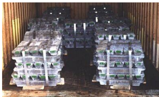
Figura 7.19 Lingotes metálicos unidos por cintas de aço (fixação não completada)
