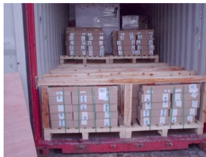
Figura 7.2 Piso temporário de madeira
