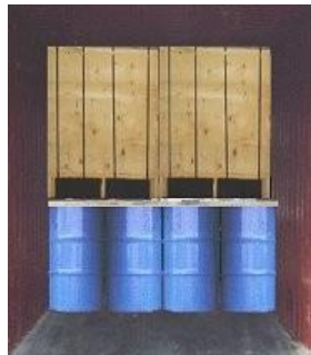
Figura 7.27 Estocagem mista, mercadoria seca sobre molhada
