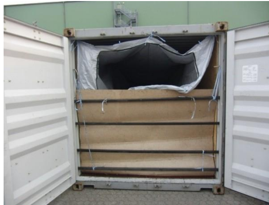
Figura 7.54 CTU com saco de lona para acomodar uma carga a granel sensível
