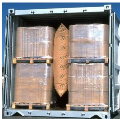
Figura 7.9 Espaço preenchido com um saco inflável central
