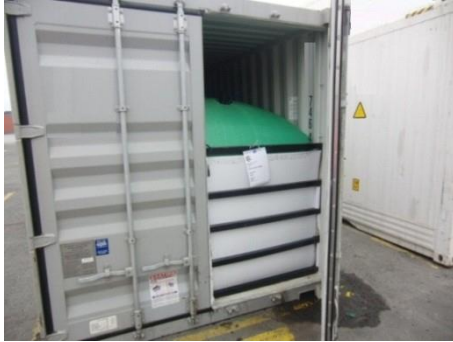
Figura 7.51 Contêiner equipado com flexitank
